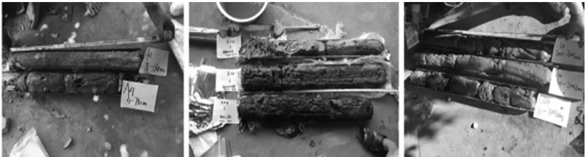
图 2 紫阳湖底泥勘探柱状采样实物
